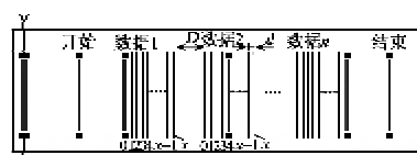
图1 脉冲位置编码SAW标签结构
