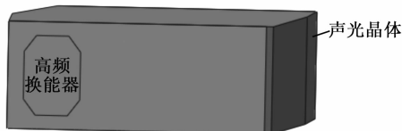
图 3 AOTF 块体高频部分热分析模型
