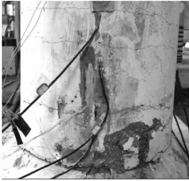
图 4 构件底部 A 面的最终破坏图
