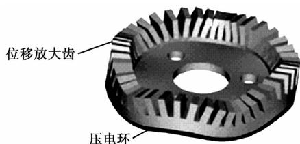
图1 超声电机定子工作状态
