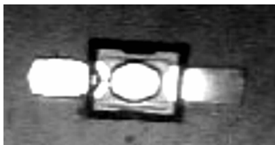
图1 梁式封装二极管透镜成像
