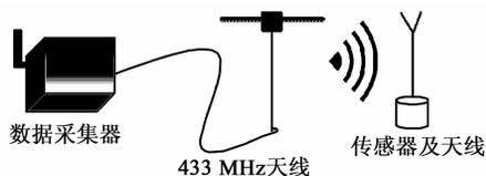
图 1 无线无源 SAW 传感系统
