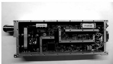
图3 某型卫星导航系统的一种接收机射频模块测得前端中各级电路的线性参数如表4所示。
