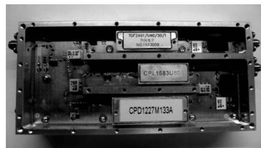
图 2 某型卫星导航系统的一种接收机低噪放模块
