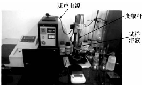
图11 超声辅助消解水样的实验体系
