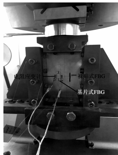
图 5 标定及对比试验加载现场
