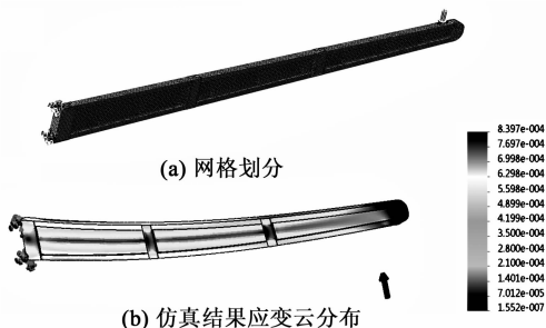
图3 工字梁屈曲变形云图
