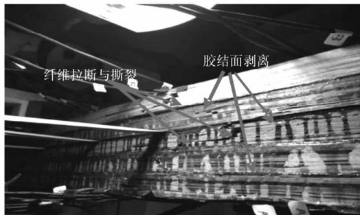
图3 构件底面破坏形态(中段底部)
