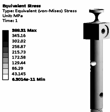
图6 弹性球铰链的等效应力
