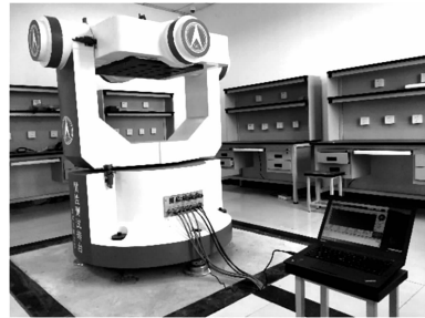
图 3 高精度三轴转台
