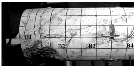
(b) 支座(传感器B1~B4)裂缝分布
