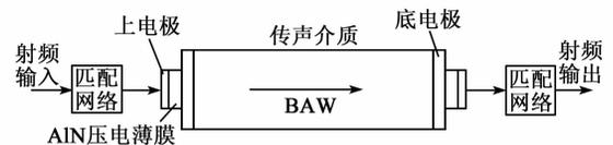
图 1 BAW 微波延迟线和薄膜换能器结构示意图
