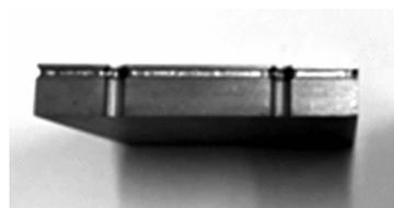
图 8 异型激光缝焊试验图片
