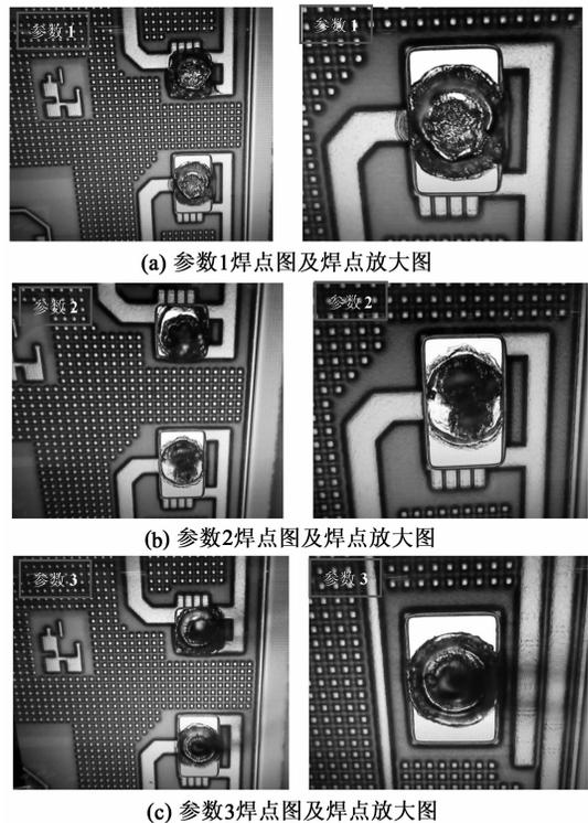
图3 键合 300 °C, 烘烤 24 h 后的多功能芯片键合焊点图
