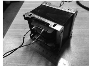
图6 实验中使用的音频变压器
