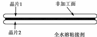
图 1 晶片粘接示意图
