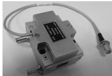
图6 声光开关外形
