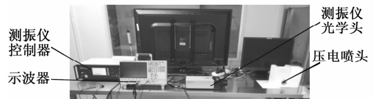
图 5 激光测振仪测定喷头的实际振幅图
