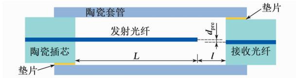
图1 光纤加速度计结构原理图
