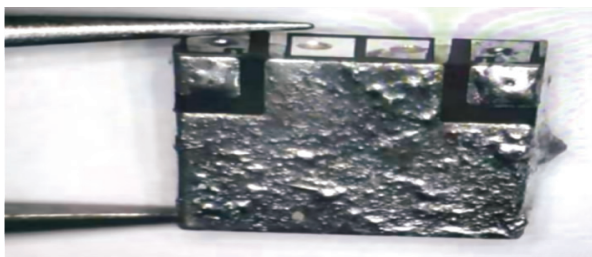
图 12 满足可焊性耐焊接热要求的滤波器
