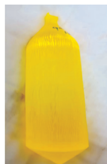
图5 GAGG晶体实物
